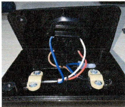
Foto 19 – Vista interna do controle de velocidades
