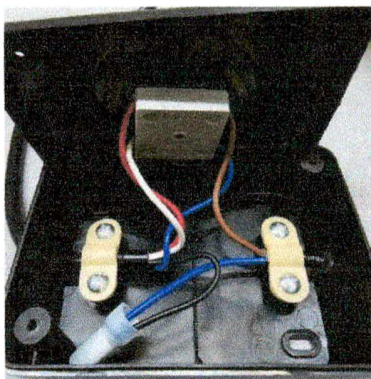
Foto 7 – Vista interna do controle de velocidades
