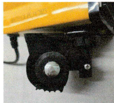
Foto 4 – Eixo de ajuste de inclinação
